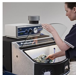
Macchine sabbiatrici ESD per rimuovere la vernice dalle schede elettroniche
